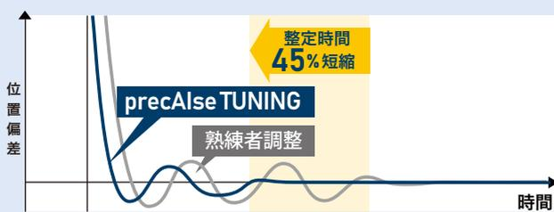
※当社実験環境による測定。位置偏差が所定の調整幅に収まるまでにかかる調整時間を測定
