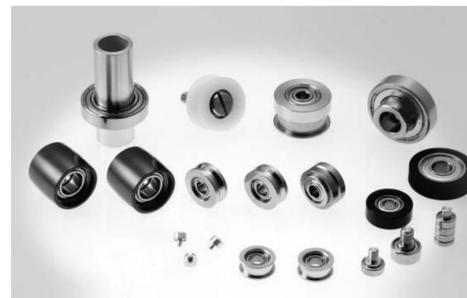
ミネベア製プーリーはミネチュア玉軸受の外輪に圧入・接着・モールド等の方法により、各種材料、形状のプーリーをアッセンブリーした構造となっています。
